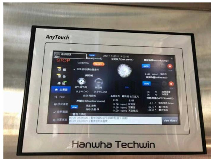
2、空压机 K001A 的润滑油过滤器压差就地显示在绿区，PLC 显示数据 1.97kg/cm<sup>2</sup>，报警值 1.74 kg/cm<sup>2</sup>，联系空压机厂家确认故障原因及处理措施。
