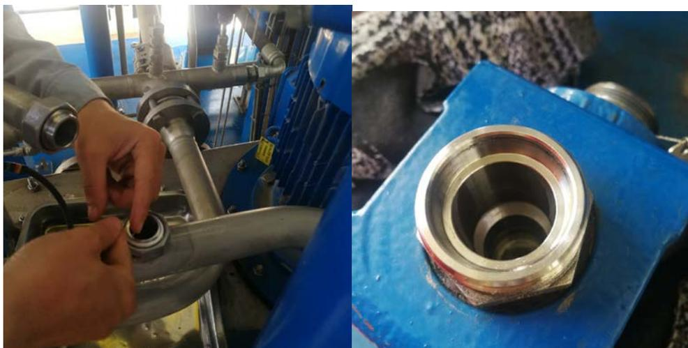
6) 利用空分空压装置停车机会，将空压机油系统的润滑油过滤器接头、油压探头、油冷器管线法兰等漏油点进行消漏处理。
