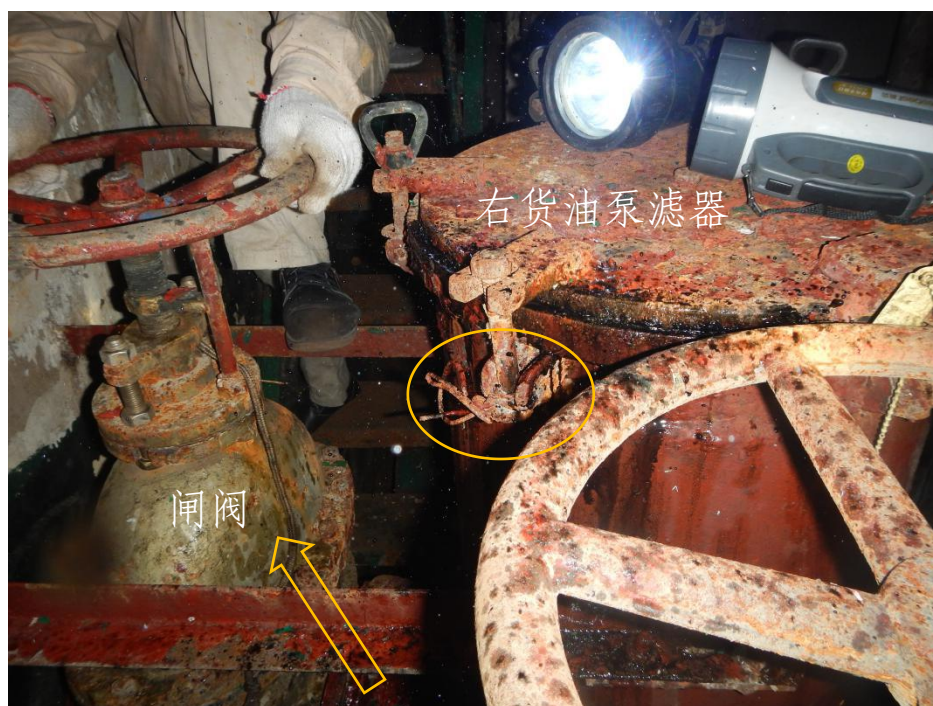
图 2 右货油泵滤器前进口闸阀/滤器压盖螺杆端部轴销用铁丝代替
