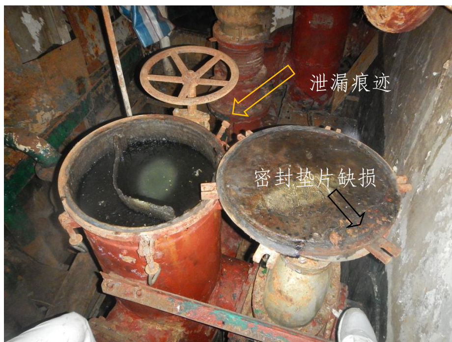
图 3 右货油泵滤器压盖打开状态
