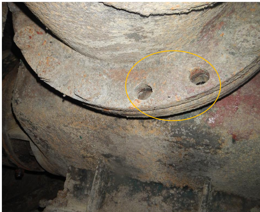
图 16 左货油泵与滤器连接管法兰螺丝缺失
