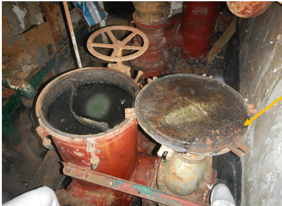
图 5 泵舱货油管滤器内部图
