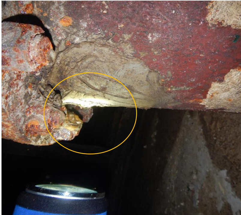
图 15 与货舱壁连接处排出管的铁水泥修补
