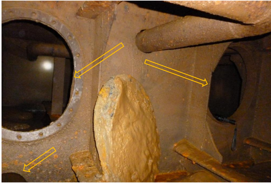
图 19 右舷 6、7 号压载舱分隔舱壁除道门外另有开孔
