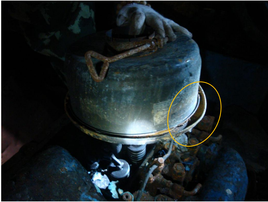
图 10 3 号发电机进气口空气滤清器脱落膨胀变形
