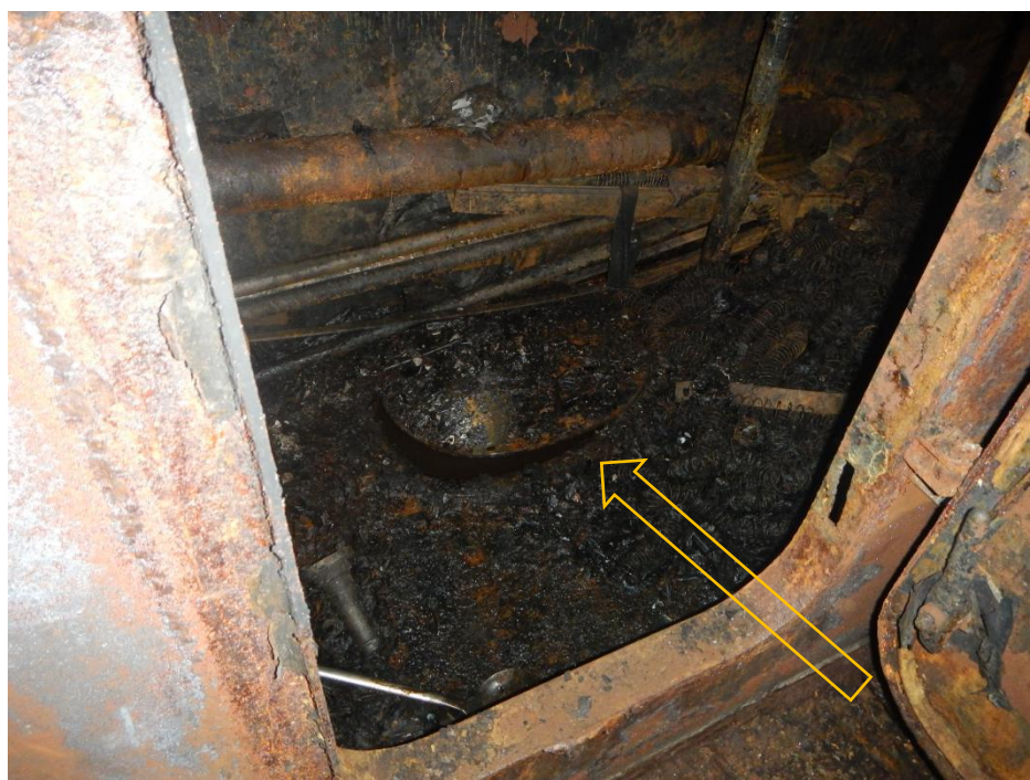
图 14 艏重油舱人孔盖未上螺丝紧固
