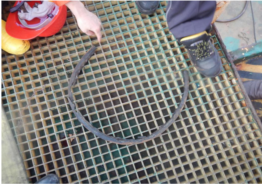
图 4 右货油泵滤器压盖上的密封垫片残缺
