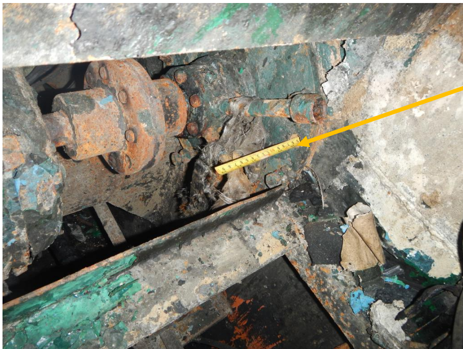
图 6 泵舱右压载泵穿舱轴法兰盘图
