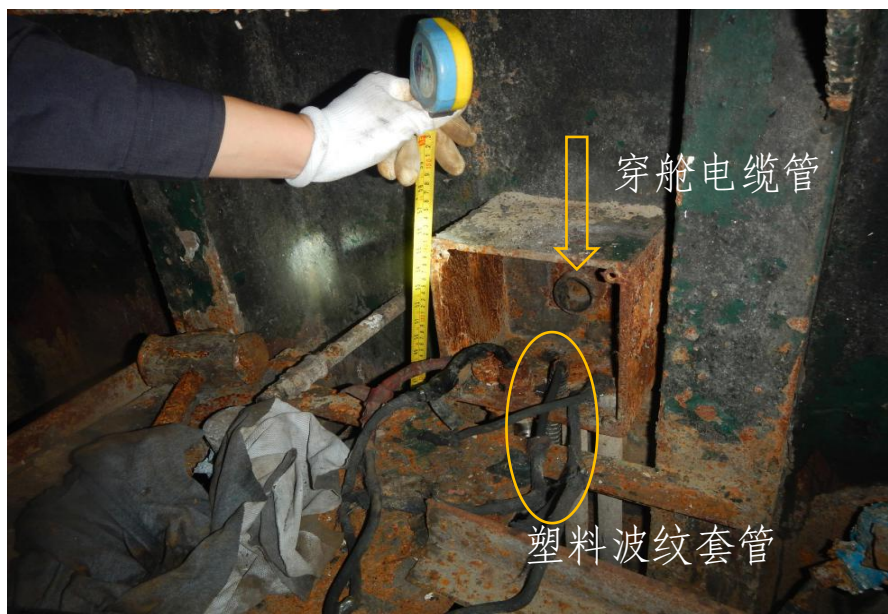
图 5 穿舱电缆管（泵舱拍摄）
