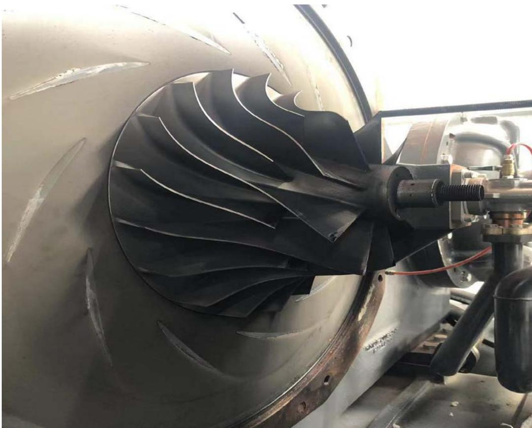
3) 导叶及叶轮入口蜗壳底部有硬化油污状脏污, 判断是导叶关节润滑脂, 运行中渗入。
