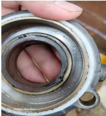
2) 12月27日，P2004C泵振动大，联系设备检修部对其进行拆检，发现轴承滚动有卡涩现象，更换轴承后运行正常。
