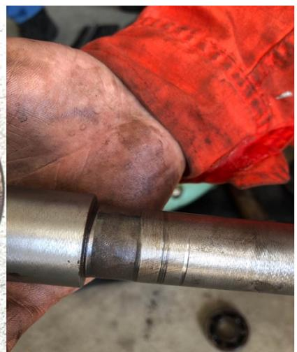
2) 2020年2月7日, 巡检发现 5152-P2009B 含盐二段剩余污泥泵有异响, 拆检发现轴承卡死, 更换轴承, 清理轴承箱后, 运行正常。
