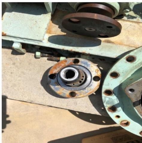
2) 2020年3月12日，5152-P1004B 不上量，拆检发现工作叶轮有腐蚀。更换叶轮，运行正常。
