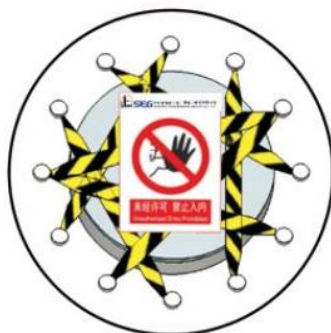
辅助通风的法兰封闭 防护材料：警戒带、标识牌
