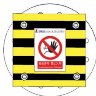
法兰封闭 防护材料：木模板、螺栓、标识牌
