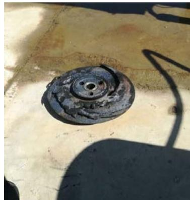
3) 2020年3月18日, 碱渣 BAF B 罐碱渣入口流量计前法兰与管焊接处沙眼泄漏, 联系检修进行补焊, 恢复正常。主要是焊缝热影响区碱渣腐蚀, 建议后续碱渣管线更换为碳钢衬塑, 可有效降低碱渣腐蚀泄漏。
