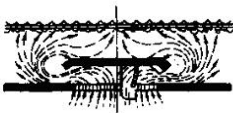
图2-58 浮阀塔盘上气液接触状况
